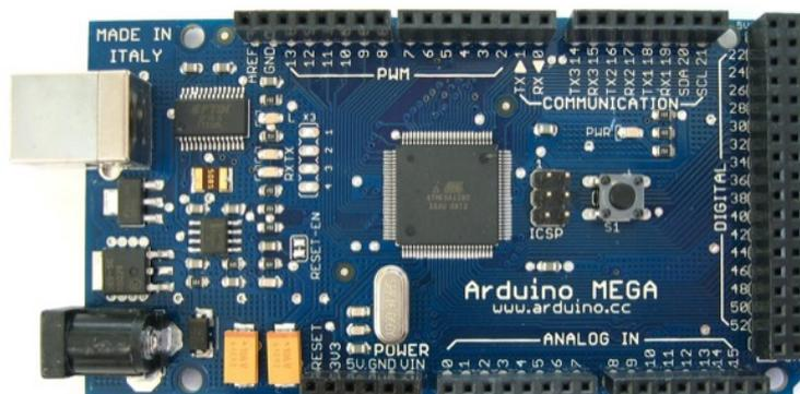
Рисунок 5 – Плата Arduino Mega 2560
