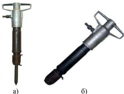
Рисунок 24 – Бетоноломы пневматические ударные: а) – ИП-4609; б) – ИП-4607
