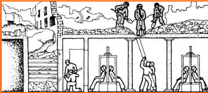
Рисунок 66– Устройство отверстия в перекрытии
