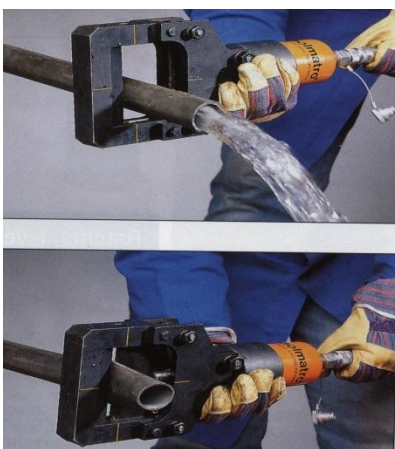
Рисунок 14 – Устройство для пережатия труб
