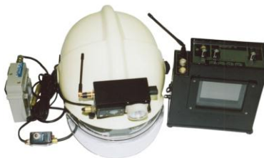
Рисунок 47 – Комплекс «Шлем» (универсальный видео-радиофицированный шлем спасателя)
