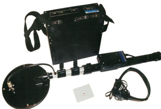
Рисунок 45 – Радиолокационная система поиска с использованием пассивных маркеров СМП-1П
