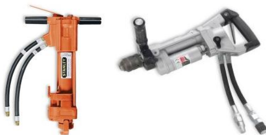
Рисунок 22 – Перфораторы с гидравлическим приводом фирмы «Stanley»
