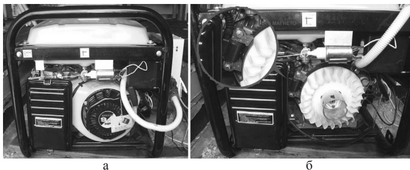
Рис. 41. Общий вид генератора на жидком топливе: а) место установки магнето зажигания; б) место расположения заслонки «газа».
