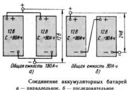
Рис. 66. Схемы соединений аккумуляторов в системах ИБП.
