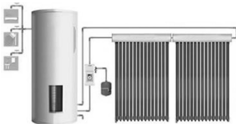
Рис. 11. Общий вид системы СВНУ с вакуумными коллекторами высокого давления.
