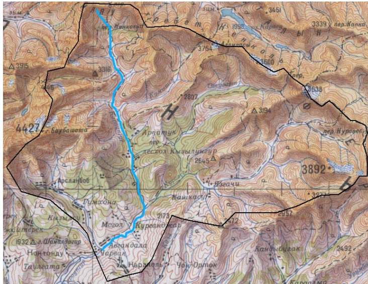
Рисунок 2.3 – Водосбор р. Кара-Ункур. Отбивка бассейна проводится по водораздельным линиям
