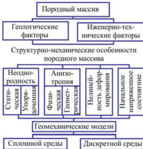
Рисунок 5.1 – Схема к составлению геомеханической модели породного массива
