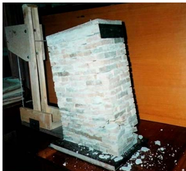
Рисунок 3 – Разрушение усиленного образца произошло при нагрузке 10,67 кН.
