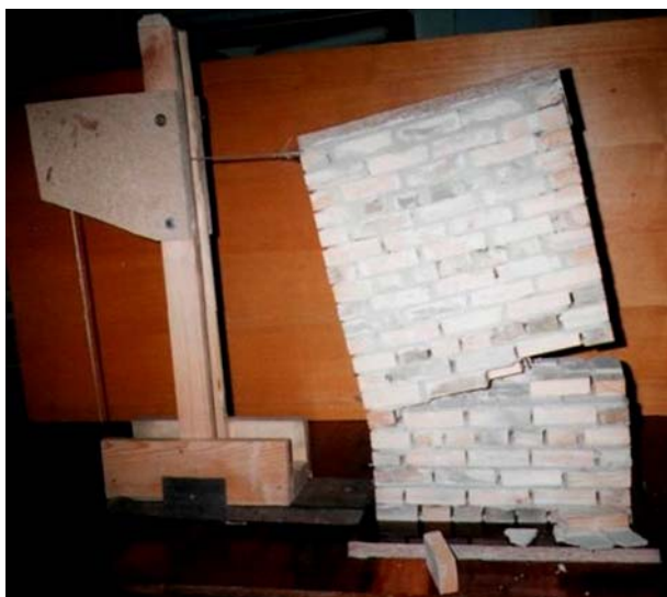
Рисунок 2 – Разрушение образца без усиления произошло при нагрузке 0,135 кН.
