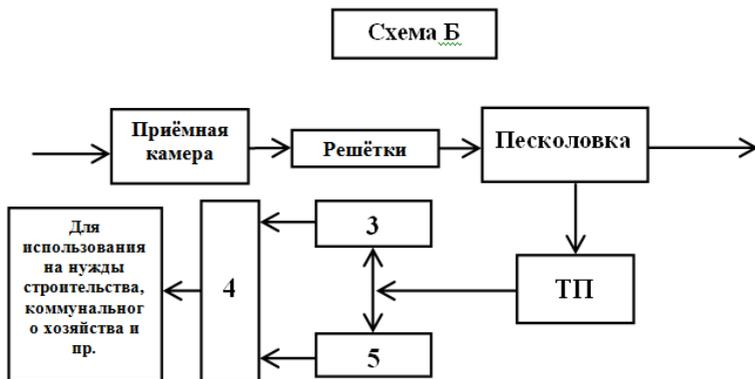
Рисунок 5 – Технологическая схема обработки осадков сточных вод, улавливаемых песколовками
