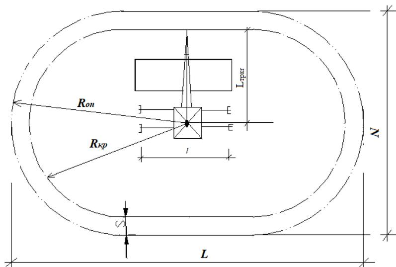
Рисунок 9. Схема определения опасной зоны работы крана
