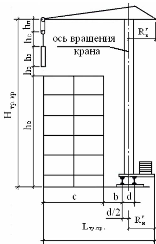
Рисунок 7. Схема для определения параметров башенного крана
