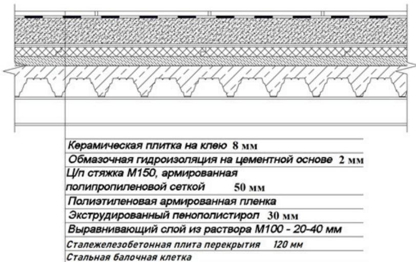
Рисунок 2.7 – Узел 2. Конструктивное решение перекрытия
