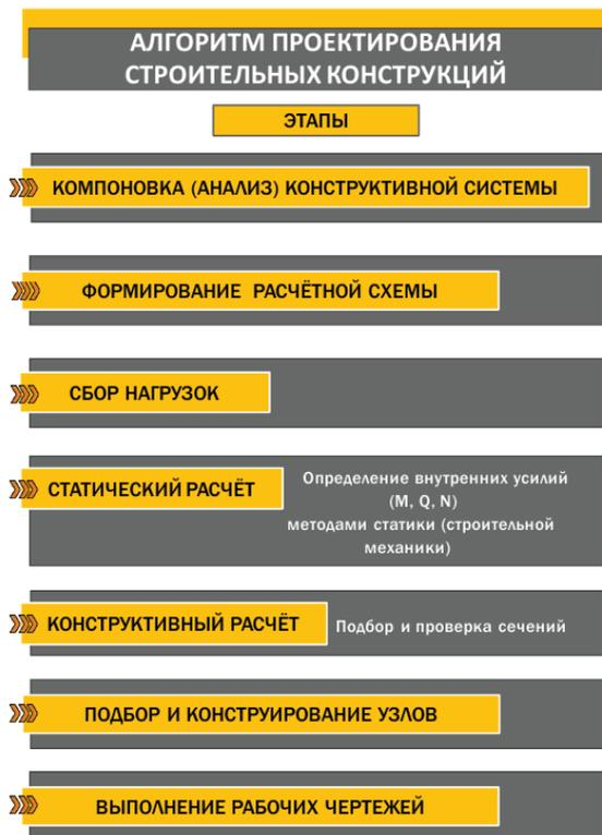
Рисунок 1 – Алгоритм проектирования
