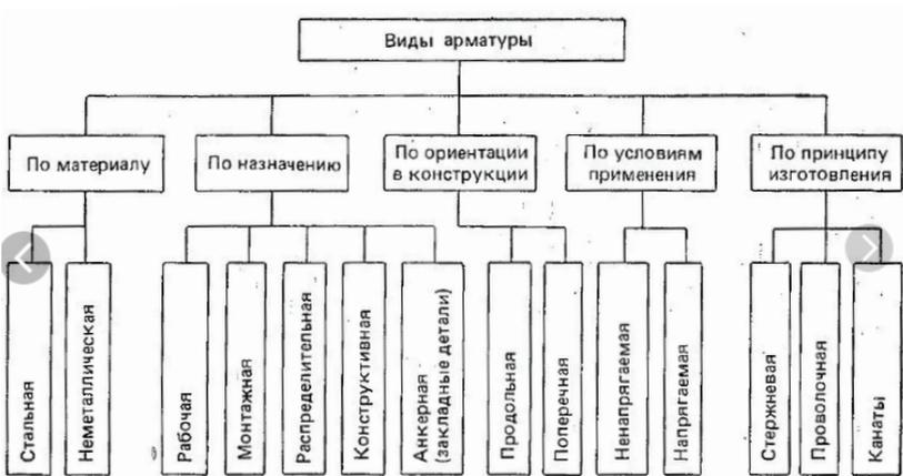
Рисунок 3.7 – Виды арматуры для железобетонных конструкций
