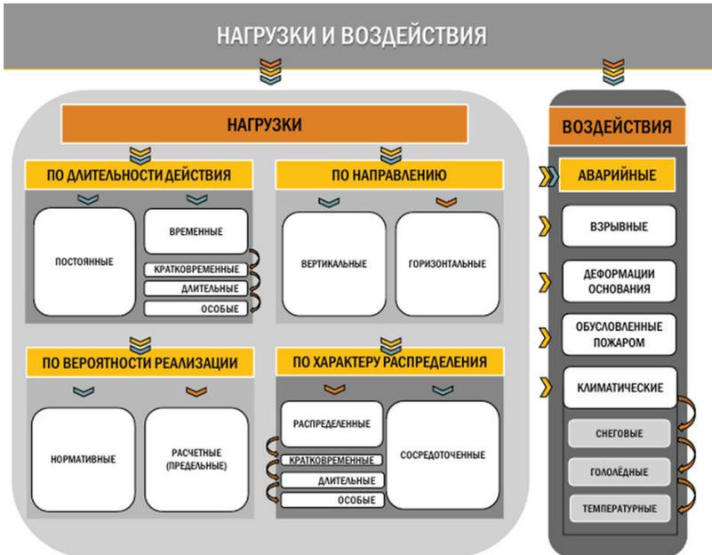
Рисунок 2.2 – Нагрузки и воздействия. Классификация
