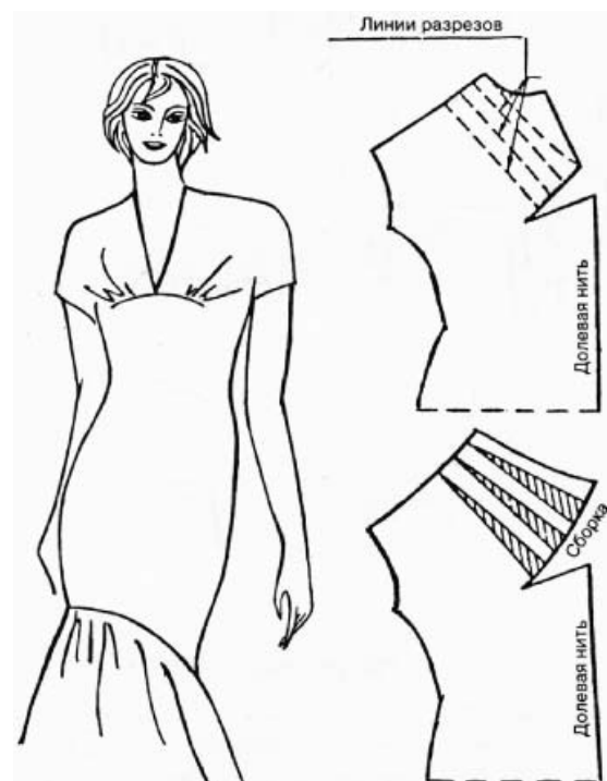
Черт. 15. Проектирование кокетки, расположенной по линии груди.
