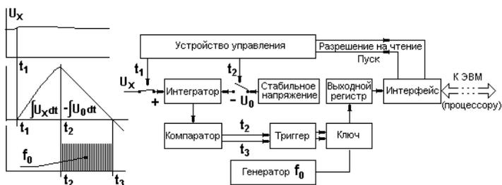
Рис. 8.10. Структурная схема интегрирующего аналого-цифрового преобразователя
