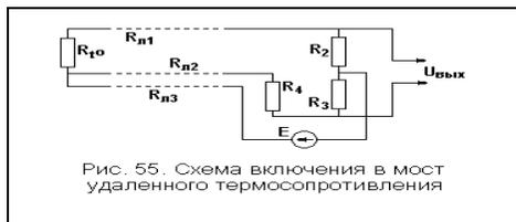
Рис. 6.5. Схема включения в мост удаленного термосопротивления
