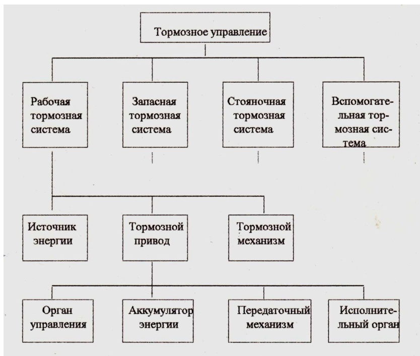
Рис. 1. Структурная схема тормозного управления
