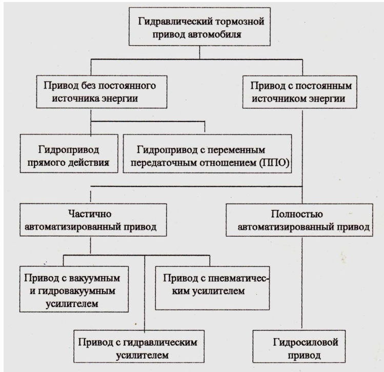
Рис. 2. Классификация тормозных гидроприводов автомобилей
