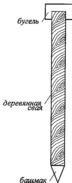
Рис. 6.7. схема деревянной сваи
