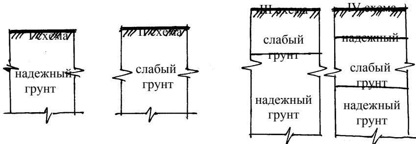
Рис. 3. Схемы геологических разрезов.
