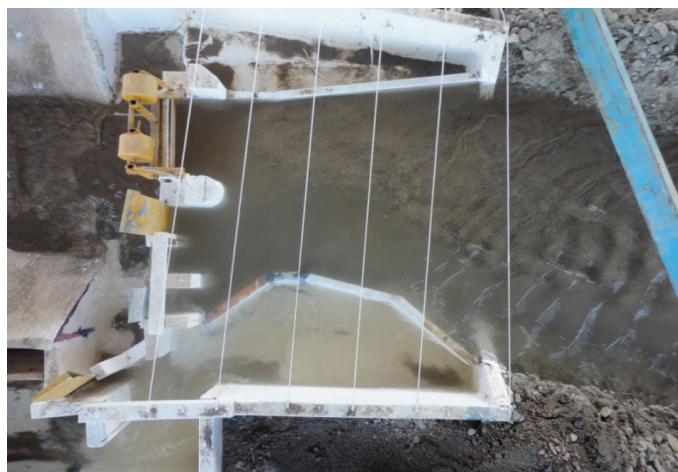
Рисунок 4.9 – Модель водозаборного сооружения из горных рек М 1:20 (поисковые исследования четырехсекционного ломаного в плане наносозащитного порога)
