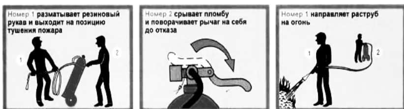
Рис. 8. Приведение в действие передвижного углекислотного огнетушителя
