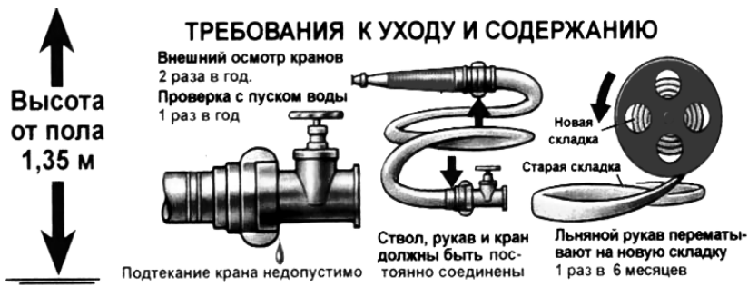
Рис. 4. Требования к уходу и содержанию пожарных кранов
