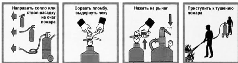
Рис. 12. Приведение в действие порошкового огнетушителя закачного
