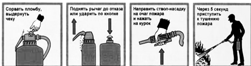
Рис. 13. Приведение в действие порошкового огнетушителя со встроенным источником давления
