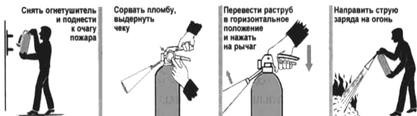
Рис. 7. Приведение в действие ручного углекислотного огнетушителя
