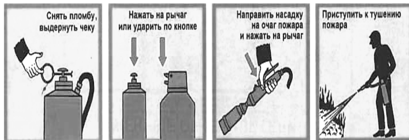
Рис. 17. Приведение в действие воздушно-пенного огнетушителя
