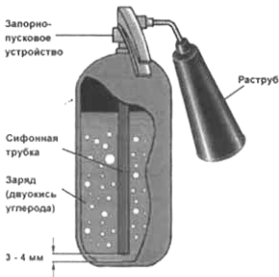
Рис. 6. Конструкция углекислотного огнетушителя
