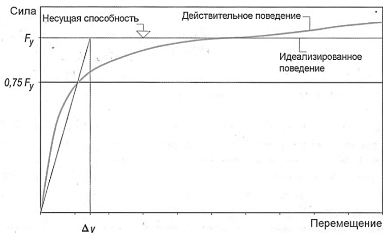
Рис. 1.10. Билинейная диаграмма «сила-перемещение» для стен с металлическим каркасом при сухом способе строительства
