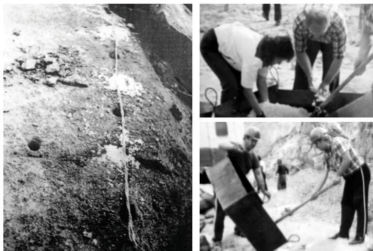
Рисунок 7 – Подготовка взрывчатых составов, заряды в шпурах и результаты взрыва состава плотностью 0,015 г/см<sup>3</sup> (слева) и плотностью 0,005 г/см<sup>3</sup> (справа) в розовом граните
