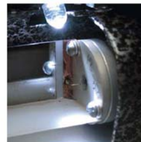
Рисунок 1.12 – Правильно установленный в манипуляторе зонд
