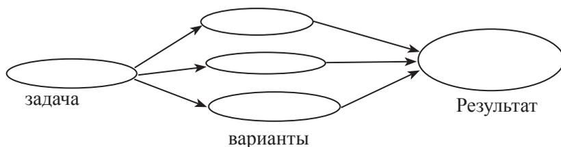
Сетевая модель состоит из двух абстрагированных элементов. Один из них называется событием, другой – связью между событиями. Под событием понимается начало выполнения или момент окончания какой-либо операции, и оно не имеет продолжительности. На сетевой модели событие обычно изображается кружком или любой другой геометрической фигурой.
