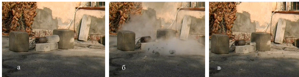
Рисунок 9 – Общий вид макета генератора взрывов зарядов из воды и разрушаемого блока породы: а – до взрыва, б – в процессе взрыва, в – после взрыва
