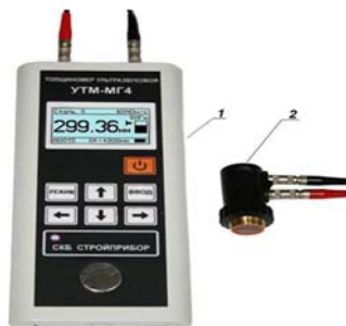
Рисунок 3.1 – Общий вид толщиномера
