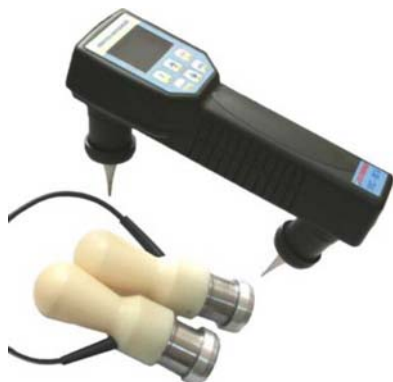
Рисунок 4.1 – Общий вид прибора УКС-МГ4 (УКС-МГ4С)
