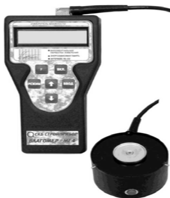
Рисунок 1.1 – Общий вид Влагомера-МГ4-Б
